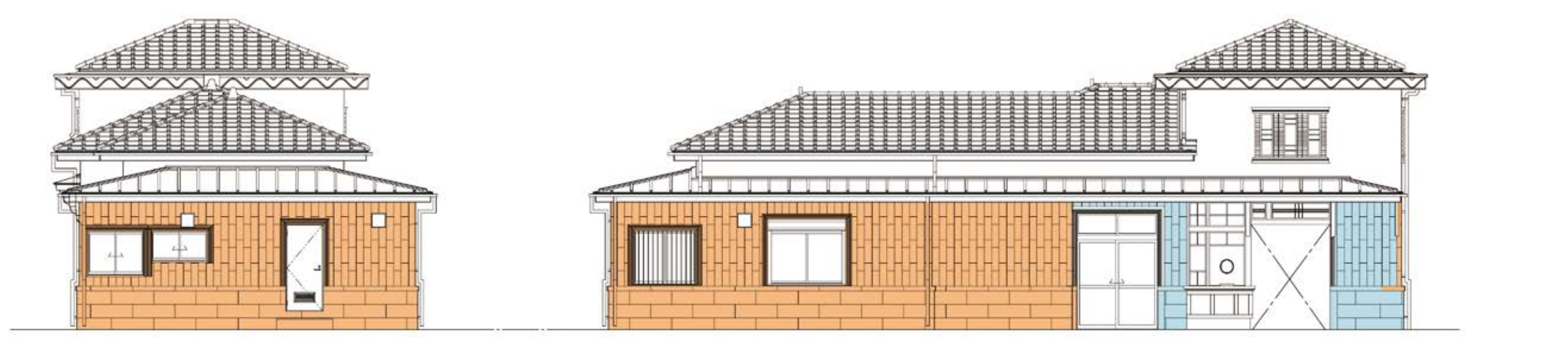
大谷石新設・交換箇所 大谷石補修箇所
